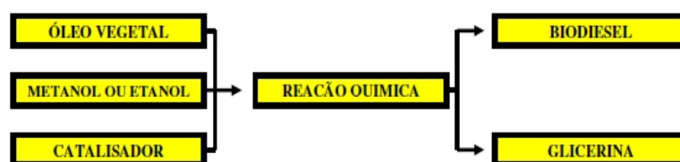
Figura 1: Ilustração esquemática do processo de transesterificação
