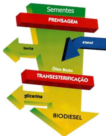
Figura 2 - Processo de produção do biodiesel
