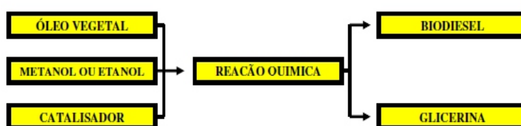
Figura 1: Ilustração esquemática do processo de transesterificação
